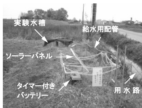
図1 川島町N用水隣接地に設置した実験装置一式
