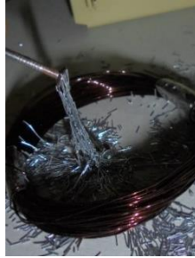
コイルの中心に入れた鉄釘が強い磁力を生じている様子
