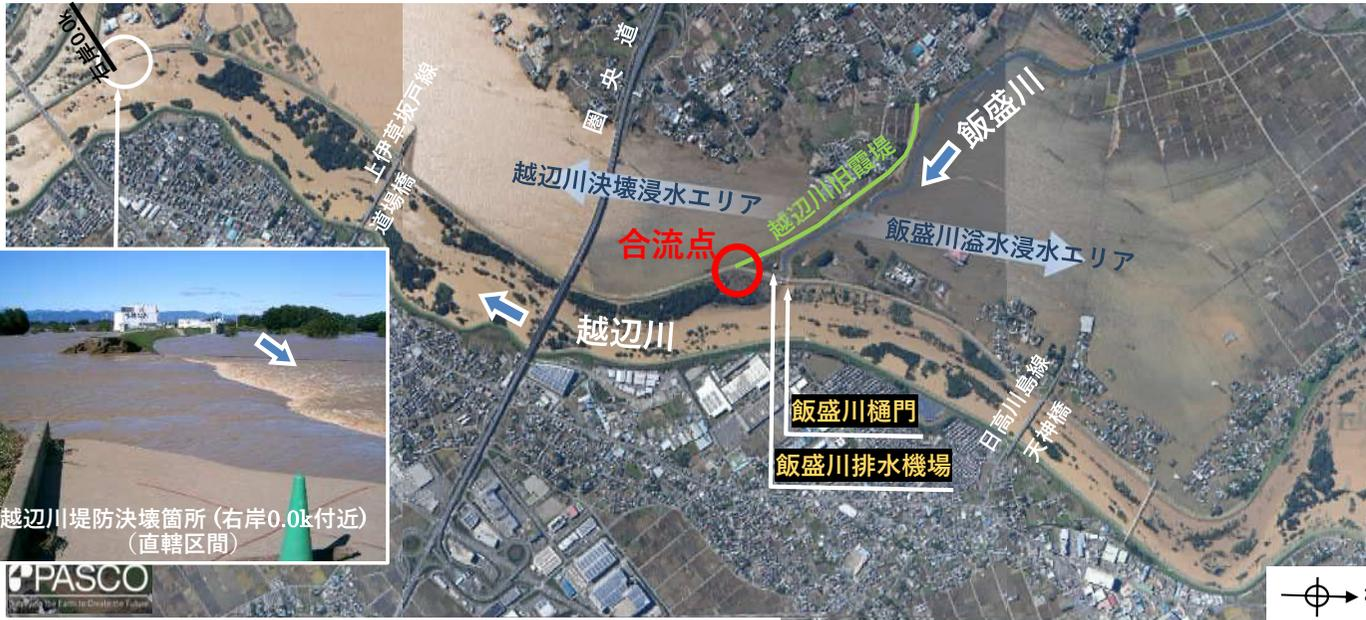
➢台風第19号の豪雨により、飯盛川流域では越辺川合流点付近から溢水し、越辺川霞堤北側の地域が浸水した。
