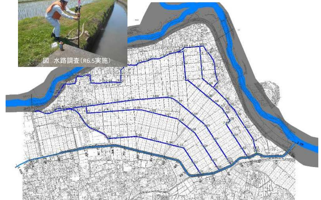
飯盛川の堤内地(堤防から住居や農地側)の水の流れを表現するため、飯盛川に接続する水路(上図青線)の測量を行い、解析モデルへ反映しました。
