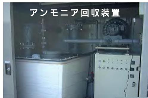
数万 ppm のアンモニアも瞬時に回収し、リン安肥料となります。
