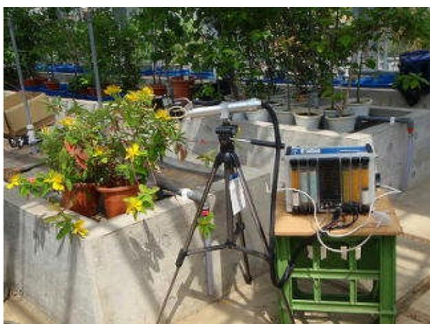
光合成蒸散測定装置での
