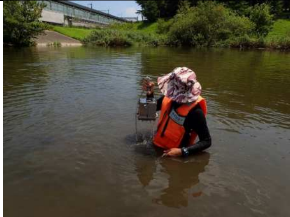
定量採集（エクマン・バージ型採泥器） 作業状況
