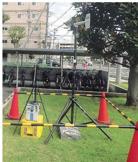
写真13-3 環境大気中の石綿濃度の測定
