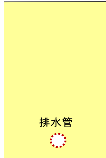
② 推進工法で 排水管設置
