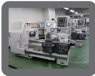
④ 旋盤 円柱・円筒形状の材料を回転させ、それに刃を当てて削る工作機械
