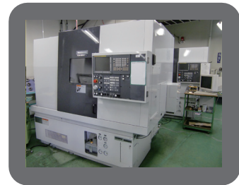
⑥ NC旋盤 数値制御が付いた旋盤で、円筒形状の材料を回転させ切削加工をする工作機械
