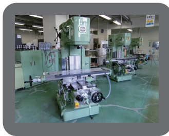
③ フライス盤 立方体形状の材料を可動するテーブルに固定し、回転する刃を当てて削る工作機械
