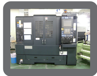
⑤ マシニングセンタ 数値制御・自動工具交換装置が付いたフライス盤で、多機能な切削加工できる工作機械
