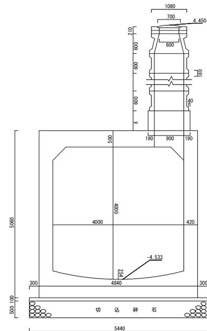
※管底高は平成8年2月調製の台帳図より。 ※地盤高数値は、直接水準による令和3年度測量成果である。
