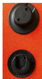
図11 脱着が容易なマグネット治具
