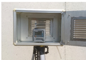
図1 ミニポンプ設置例 (大気採取中は扉を閉める)
