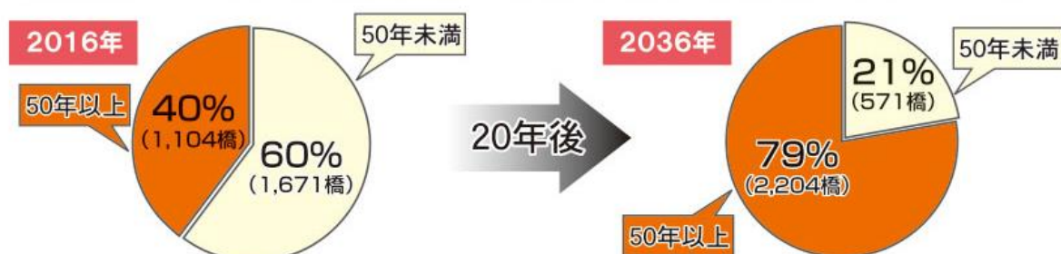
建設後50年以上経過している県管理橋りょうの割合の推移
