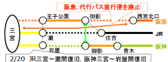
図-8 2/20時点の鉄道復旧状況
