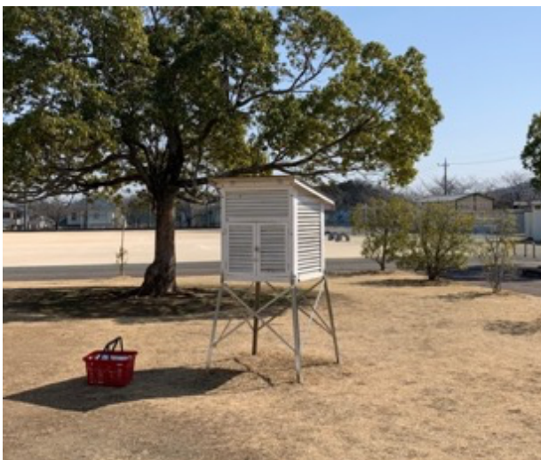
図5 小学校の百葉箱とデータロガーの設置例
