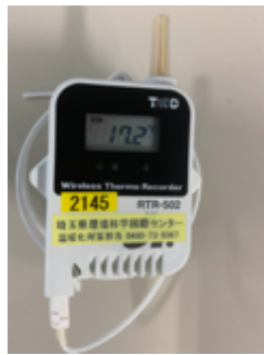
図4 使用したデータロガー(RTR-502L)
