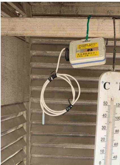
図5 小学校の百葉箱とデータロガーの設置例(上から RTR-501L、RTR-502L、LR5011)
