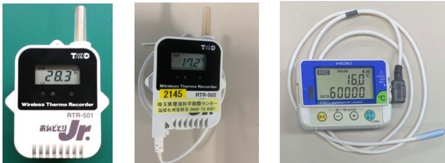
図 4 使用したデータロガーの一覧(左から RTR-501L、RTR-502L、LR5011)
