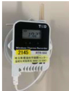
図4 使用したデータロガー(RTR-502L)
