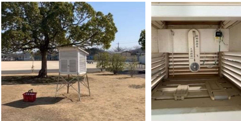
図5 小学校の百葉箱とデータロガーの設置例
