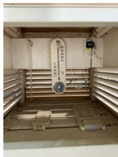
図5 小学校の百葉箱とデータロガーの設置例
