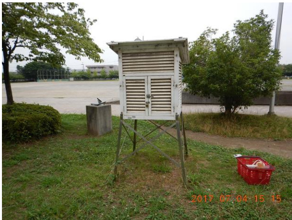
図5 小学校の百葉箱とデータロガーの設置状況の例
