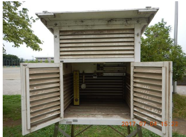
図5 小学校の百葉箱とデータロガーの設置状況の例
