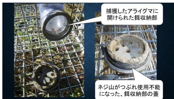
図 3 破壊されたエサ収納部 (改良前)
