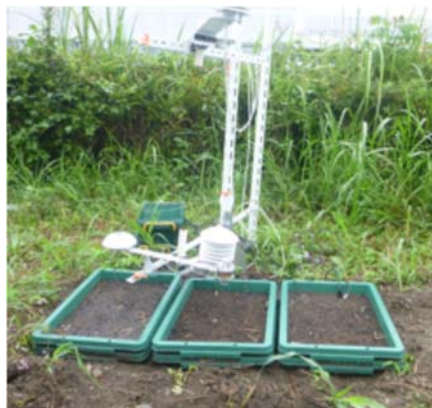
写真3 自作ライシメーターと熱収支観測機器
