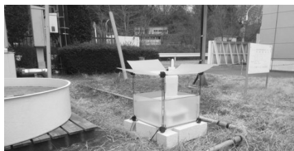
写真1 簡易蒸発計(中央)。左は比較したパン蒸発計
