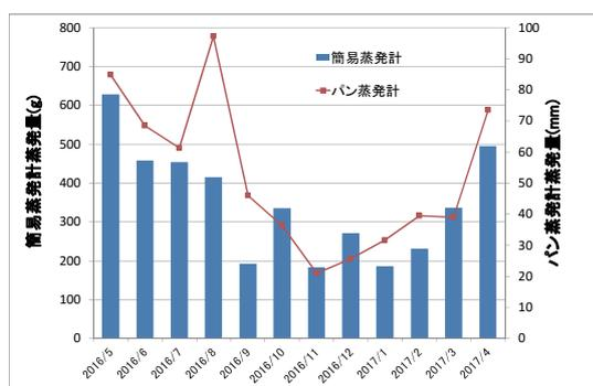
図2 簡易蒸発計・パン蒸発計による蒸発量比較
