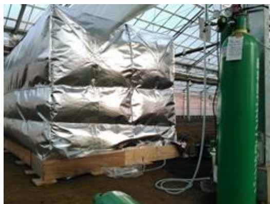
高濃度炭酸ガス処理装置
