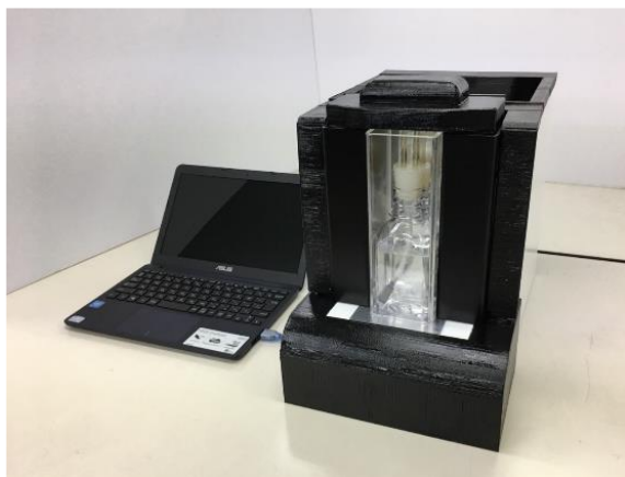
図1 水蒸気透過度測定装置
