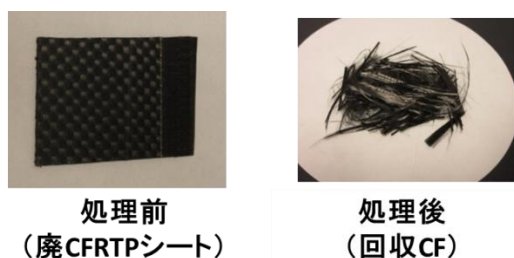
図4 溶解処理前の廃CFRTPと処理後のCF
