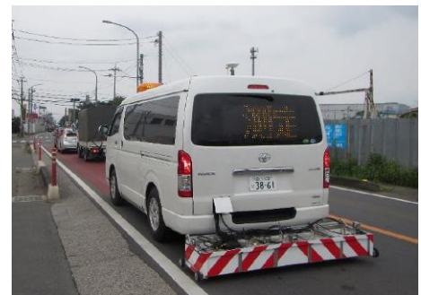
路面下空洞調査の状況
