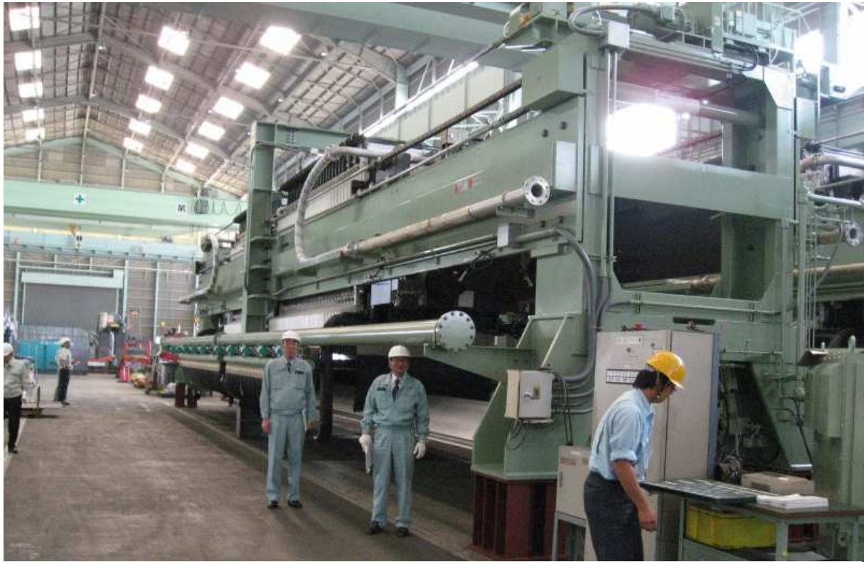
図 2-6 汚泥脱水機(工場における性能試験)
