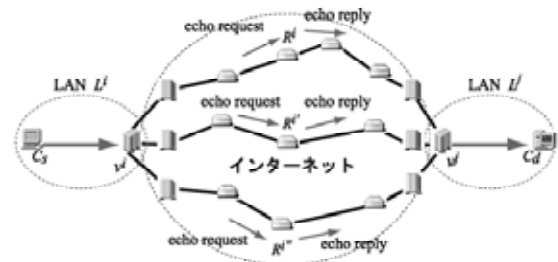
図1 IP 通信拡散法を用いた VPN 環境
