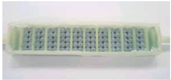
図3 光触媒と活性炭を充填したフィルター
