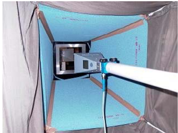
図7 ジグ内部に組み込んだ電波吸収体
