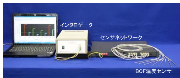
図11 8連 BOF/DWPR 温度センシングシステム
