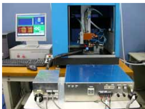
図 11 表面改質加工専用電源をデスクトップ加工機にセットした様子
