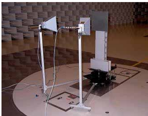
図2 角度特性の自動測定装置の外観
