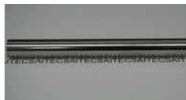
図10 丸棒（純チタン）の研磨例
