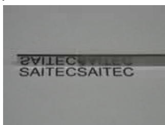
図9 標準試料の研磨例
