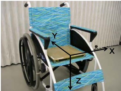
図4. 測定座標系 (矢印の方向を正とする)
