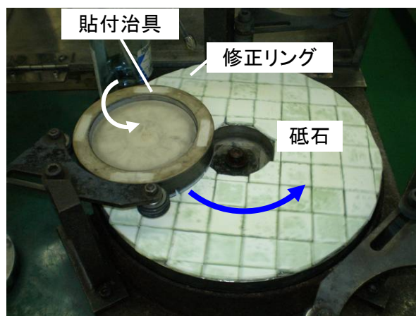
図2 片面ラップ装置による加工
