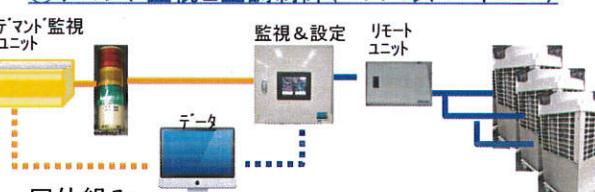
空調制御システム(ESCOT-Hyper)で、室外機の稼動を制御(0~40%)し省エネにつなげている。又、デマンドコントロールの信号により室外機を停止する。
