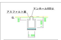
共同溝①断面図 S=1/200
