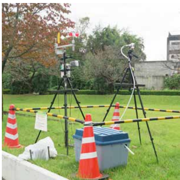
写真13-3 環境大気中の石綿濃度の測定
