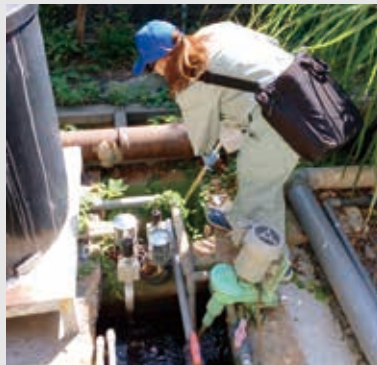
工場排水の採水・検査
