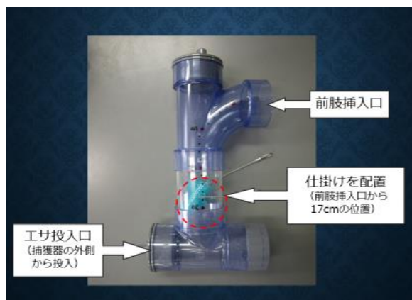
筒式トリガーの仕組み
